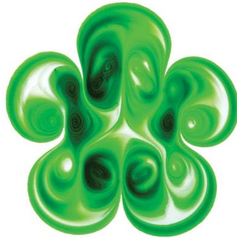
Figura 2.5: Flujo independiente del tiempo generado por ocho imanes permanentes con polaridades alternadas localizados en los vértices de un octágono inscrito en una circunferencia de diámetro 8.5 cm. a) Solución analítica para las líneas de corriente. b) Patrón de flujo experimental ( $I = 10$  mA).
