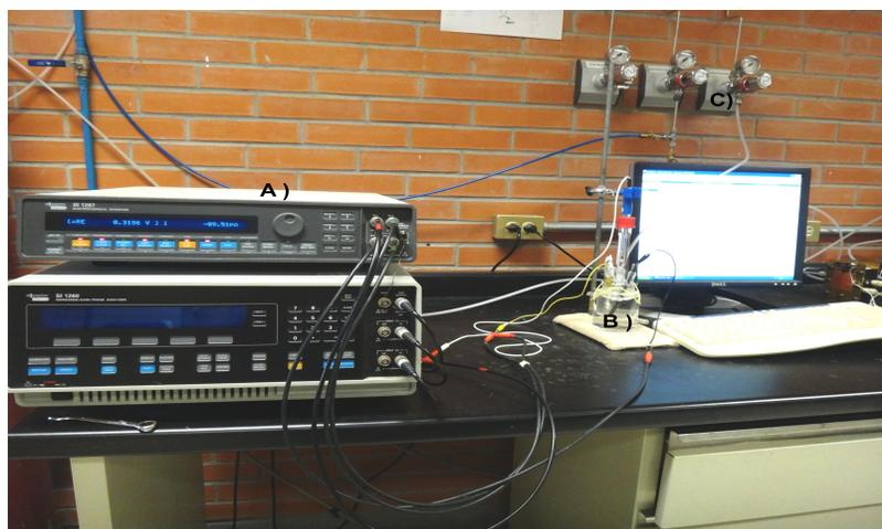
**Figura 3.5.** Sistema de caracterización para pruebas electroquímicas.
