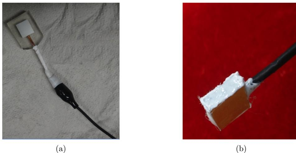
**Figura 3.1.** Electrodo aluminio (a) encapsulado con resina tipo cristal sin recubrimiento; (b) Encapsulado con polímero ABS con recubrimiento de Ni/Au.
