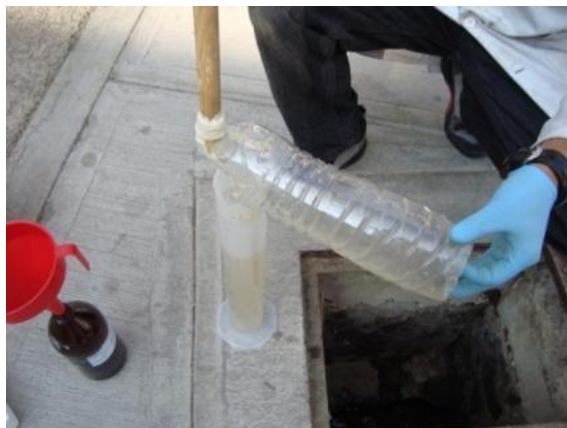
Figura 4.3. Muestreo del agua residual en un registro de hospital.
