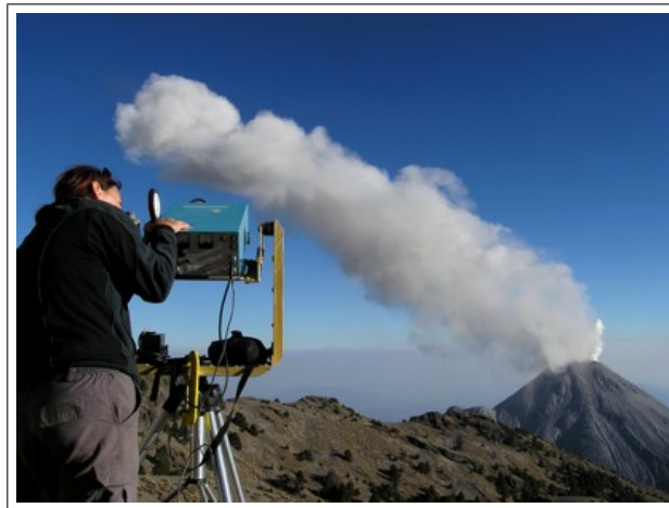
Figura 1.6: Estudiante voluntaria utilizando el COSPEC para el monitoreo de CO_2 , (foto de Nick Varley)
