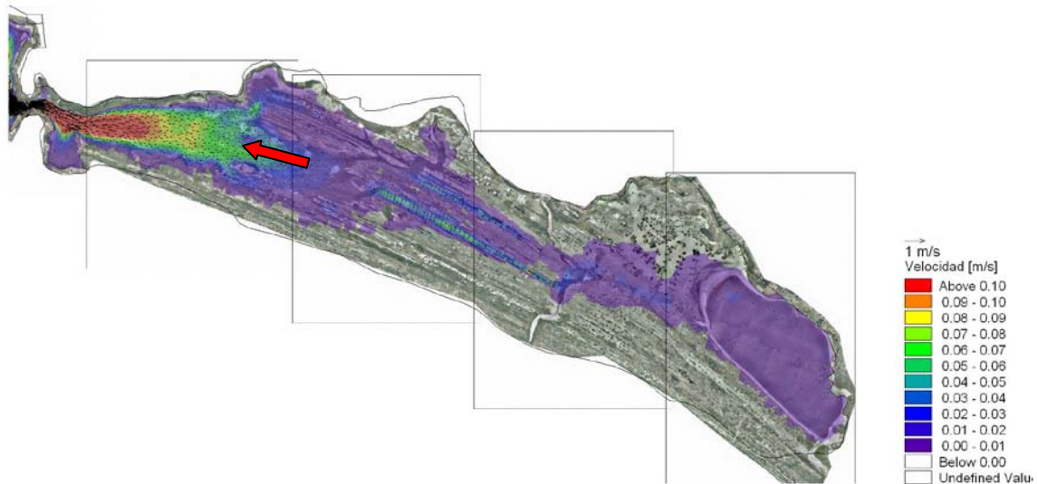
Figura VI-13 Patrones de circulación en bajamar en los vasos I y II con el canal Tepalcates abierto a 250m
