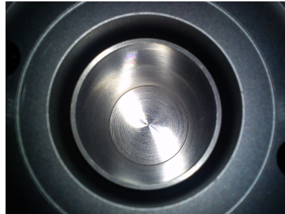
Figura 5.1-Geometría de cilindros concéntricos
