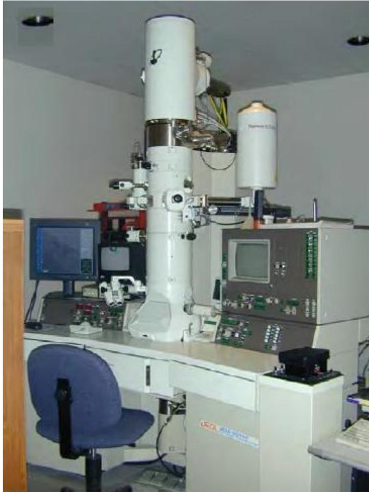
*Fig. 2.7 Microscopio Electrónico de Transmisión JEOL 2010F*
