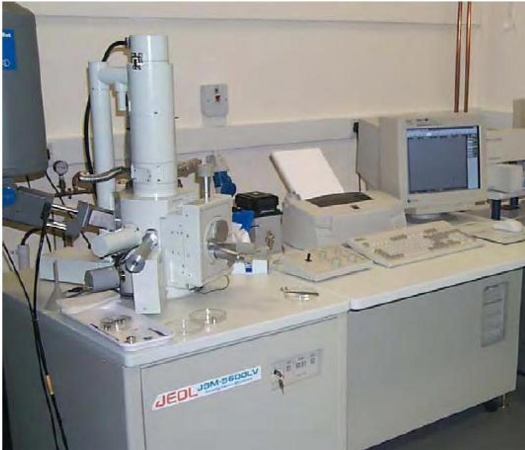
*Fig. 2.5 Microscopio Electrónico de Barrido JEOL 5600 LV*
