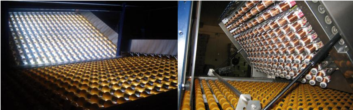
Figura 49. Ovoscopiado y detector automático de huevo sucio y fisurado respectivamente.
