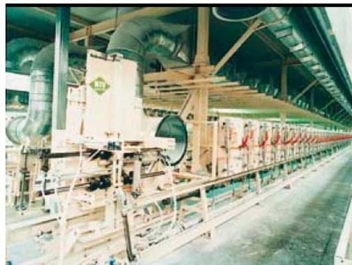
IMÁGENES. 24.2. y 25.2. **Equipo Mod.GW.** Este equipo permite la producción simultánea de tazas y bidés, a sujetar tanto a la pared como al pavimento, por colado a baja presión sobre un mismo banco. El desmoldeo del producto acabado puede efectuarse de forma manual, con asistencia neumática o bien de forma totalmente automática. Con el auxilio de un PLC (Controlador Lógico Programable) es posible llevar el control automático de todo el ciclo de producción.
