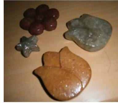
IMAGEN. 92.2. Finalmente se obtienen las piezas del material recuperado, 13 gramos de policarbonato de un CD original que pesa 15 gramos.
