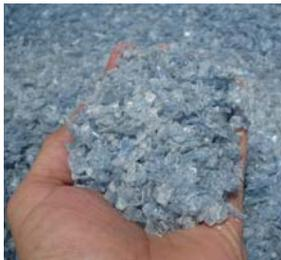
IMAGEN.89.2. A continuación se envía a una máquina extrusora para su reciclaje mecánico el proceso consiste en calentar el policarbonato hasta su punto de fusión para que adopte la forma de un hilo continuo que luego se enfría y se corta a medida de una lenteja. Este es el proceso de **granceado** que permite nuevamente la utilización del policarbonato como materia prima.
