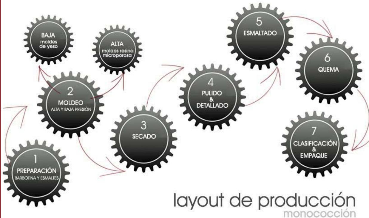
*\*Monococción.* Se denomina monococción a la cocción del proceso cerámico, desde un estado totalmente crudo hasta una completa vitrificación de la misma, la pieza se esmalta en crudo y se somete a una sola cocción, esto es un ahorro de tiempo y de energías
