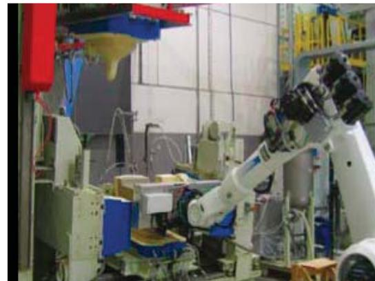
IMAGEN.33.2. Estación moldeo sanitario, molde abierto extracción de pieza con brazo robótico.
