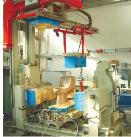
IMAGEN.34.2. Estación moldeo sanitario de una sola pieza, molde abierto.
