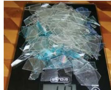
IMAGEN.88.2. Después de someterlos a un proceso de lavado se diluyen residuos de etiquetas, pintura y aluminio logrando así despintar el plástico
