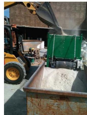
IMAGEN.82.2. Dicha materia prima pasa por varios ciclos de trituración hasta que se obtiene un material pulverizado para su posterior transformación.
