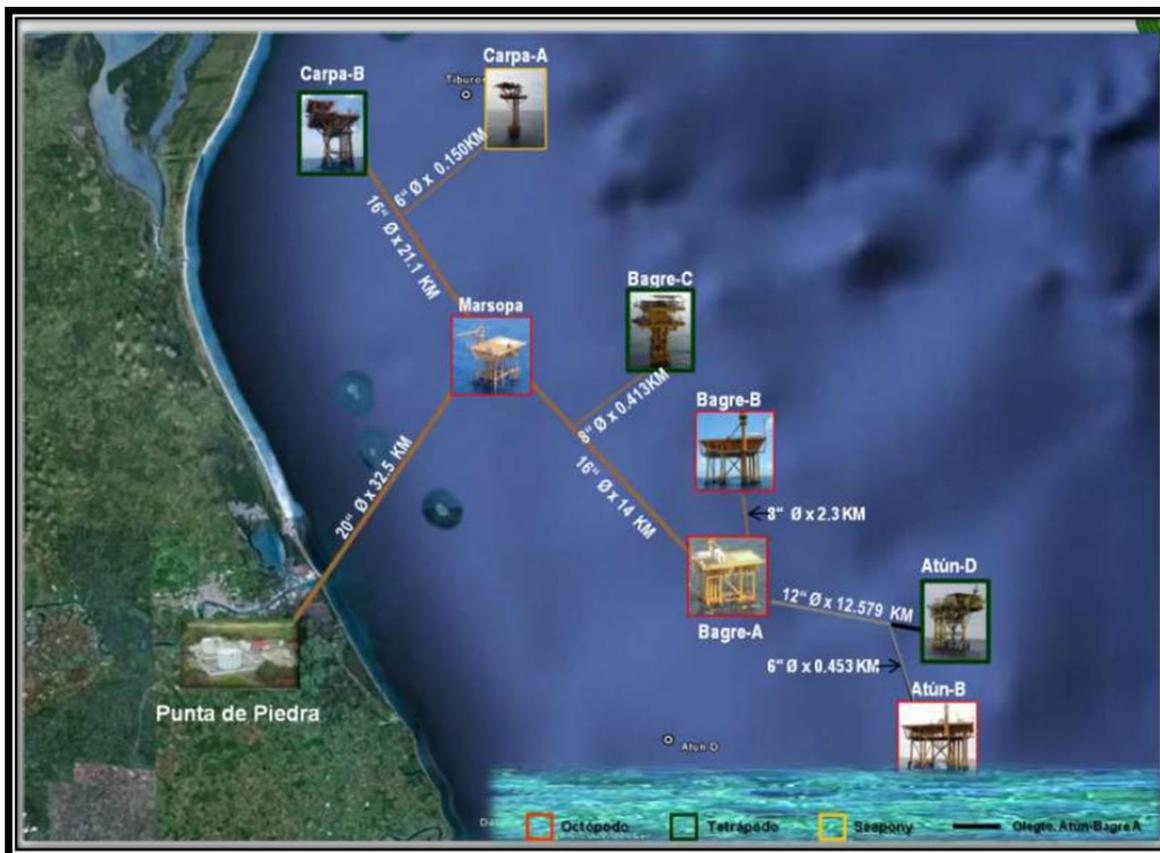
Fig. 4.13. Plataformas marinas del Bloque Atún y el sentido del flujo (Tomada de PEMEX, 2012).
