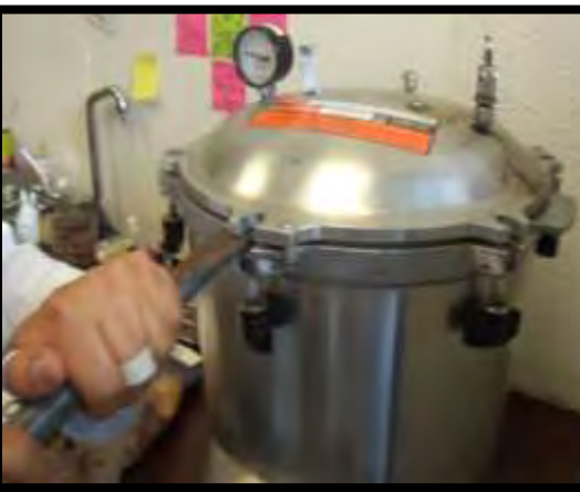
Apertura de la autoclave con un mango de apoyo.
