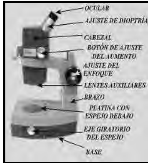
Fig. 13. Partes que componen al microscopio estereoscópico.
