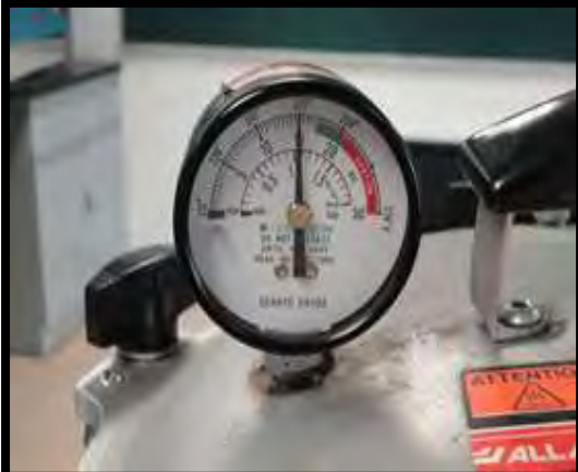
Esterilización en autoclave 15lb de presión, 121°C (250°F) y 15min.
