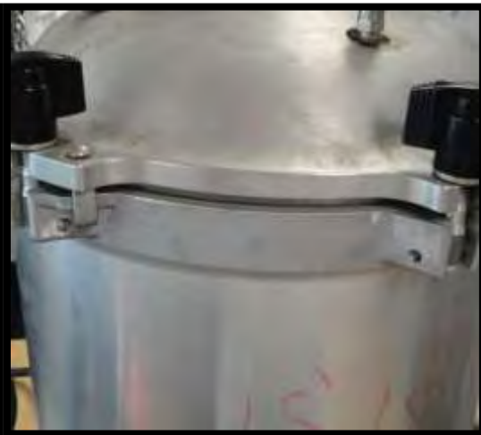
Nivelación de las tapa para evitar fugas de vapor
