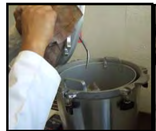
Retiro de la tapa direccionando de modo que el vapor caliente no tenga contacto con las manos.
