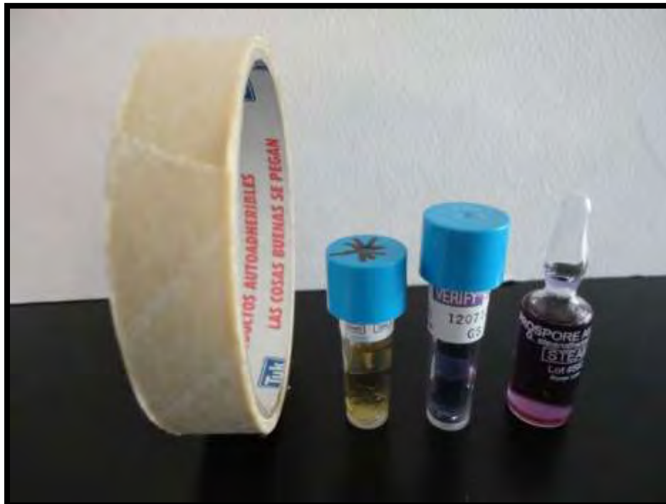
Foto 14. Indicadores biológicos y químicos utilizados para monitorear y validar ciclos de esterilización por calor húmedo.
