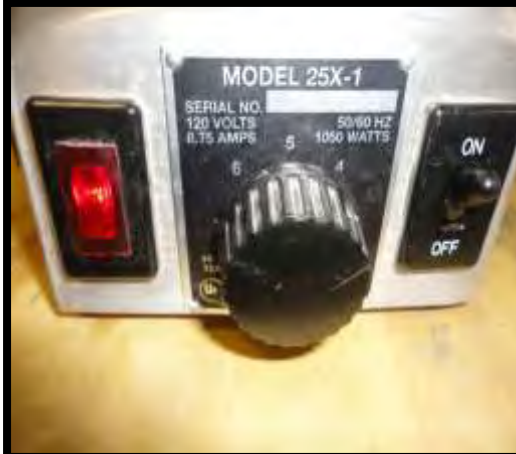
Encendido de la autoclave: girar la perilla en calentamiento alto.
