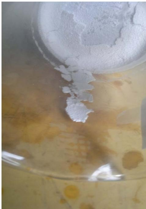
*Figura 3.3. Sólido SiO<sub>2</sub>-APBA-Ala sintetizado por sol-gel.*
