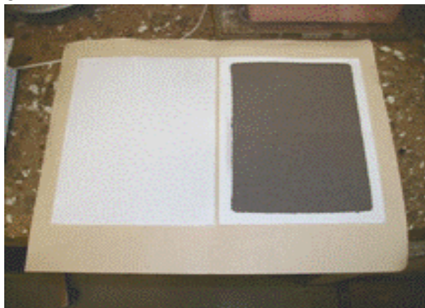
Figura 6. Procedimiento de muestreo. a. Acondicionamiento térmico de los filtros de fibra de vidrio, b. Cámara para trasladar los filtros, c. Balanza para el pesado de los
