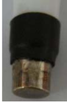
FIGURA 9: Sensor de temperatura oral implementado
