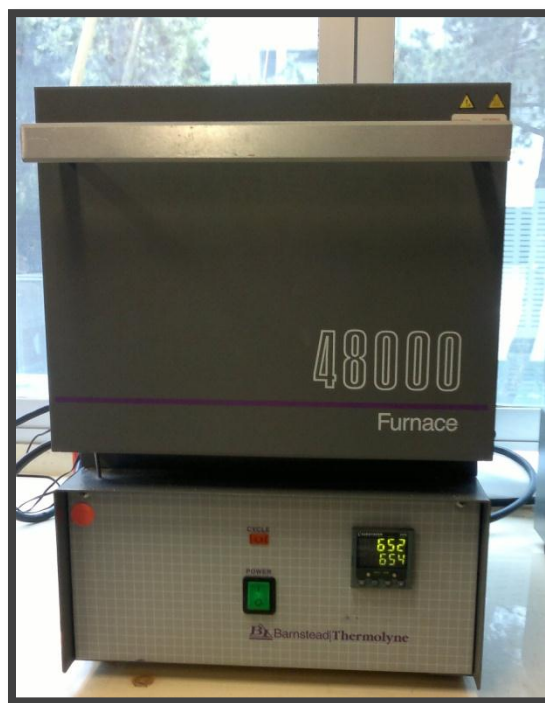
Figura 2.1. Mufla Thermolyne 48000 usada en la síntesis de \text{Na}_2\text{ZrO}_3 .
