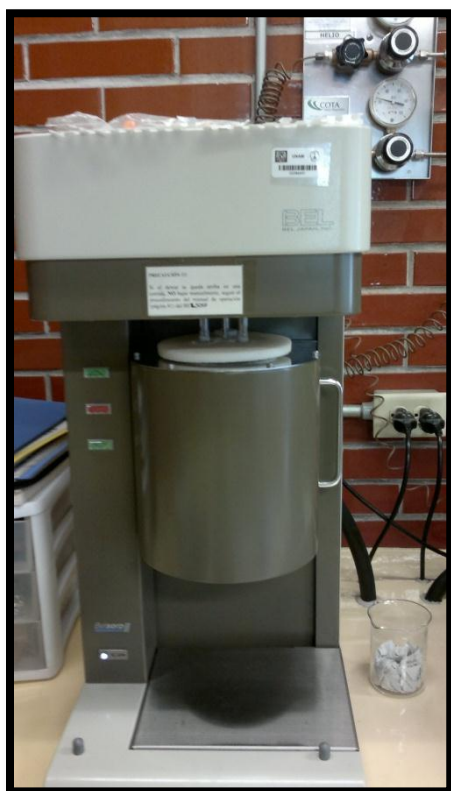
Figura 2.6. Equipo Bel Japan Minisorp II usado para medir área superficial por adsorción de nitrógeno.
