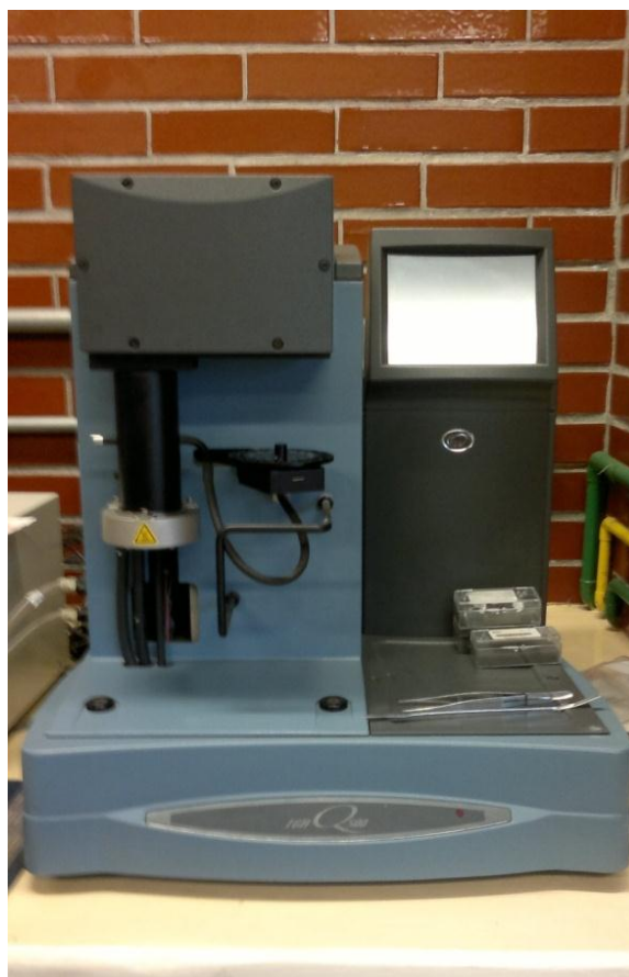
Figura 2.12. Termobalanza Q500HR utilizada para seguir la captura química de CO 2 .
