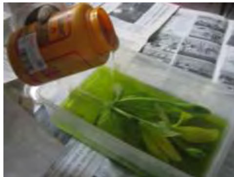
Figura 8. Flores sumergidas en la solución de resina-acetona 1:1.
