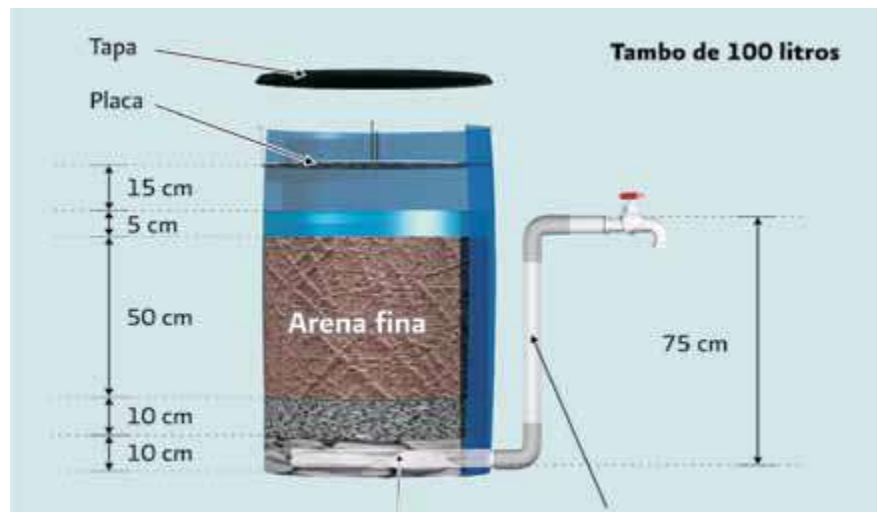
fig. 1.20 Biofiltro de Arena.
