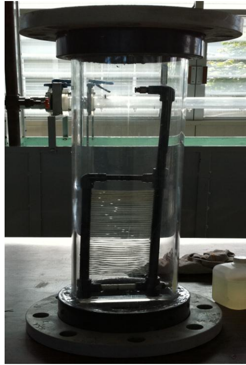
Figura 2.17. Instalación de las membranas en el módulo y montaje del módulo de membranas en el reactor de membranas.
