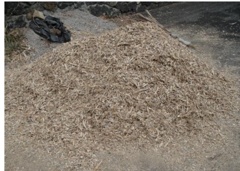
Figura 3.24. Tamizado del material orgánico. En la figura A y B ilustran el proceso de tamizado del ficus. C) muestra las tres granulometrías obtenidas después del tamizado. D) es la fotografía del tamaño de partícula a utilizar.
