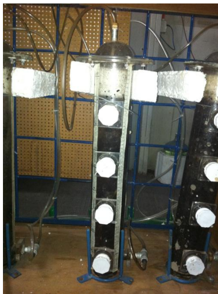
Figura 2.15. Biofiltro empacado con material de empaque orgánico.
