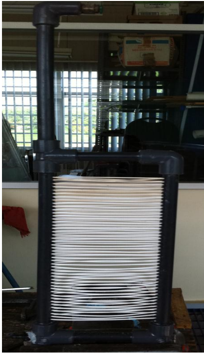
Figura 2.17. Instalación de las membranas en el módulo y montaje del módulo de membranas en el reactor de membranas.
