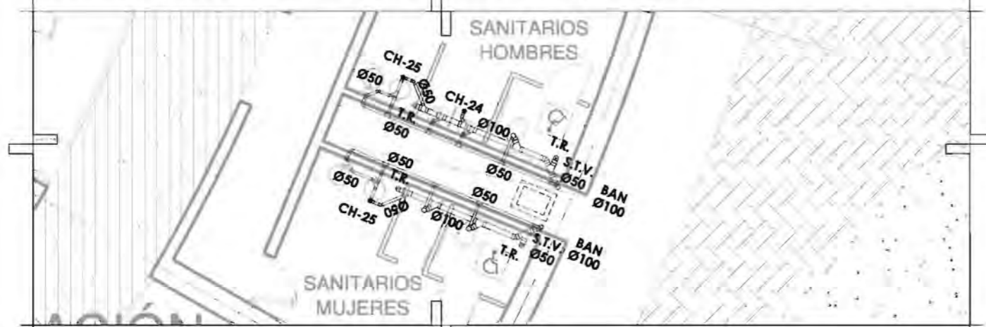
SANITARIOS ÁREA DE LUDOTECA, N.P.T. + 4.15m (ESC: 1: 50)
