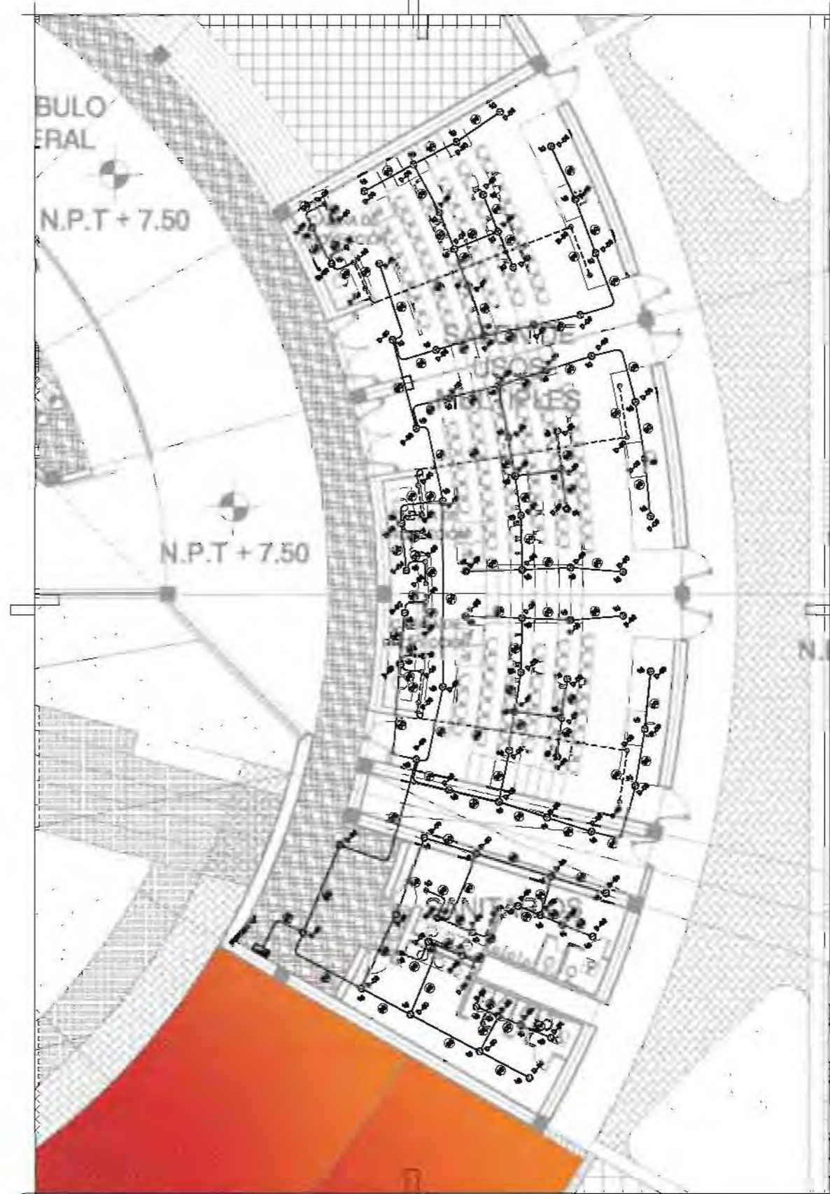
INSTALACIÓN ELÉCTRICA NIVEL + 7.15 m (ESC: 1: 100)
