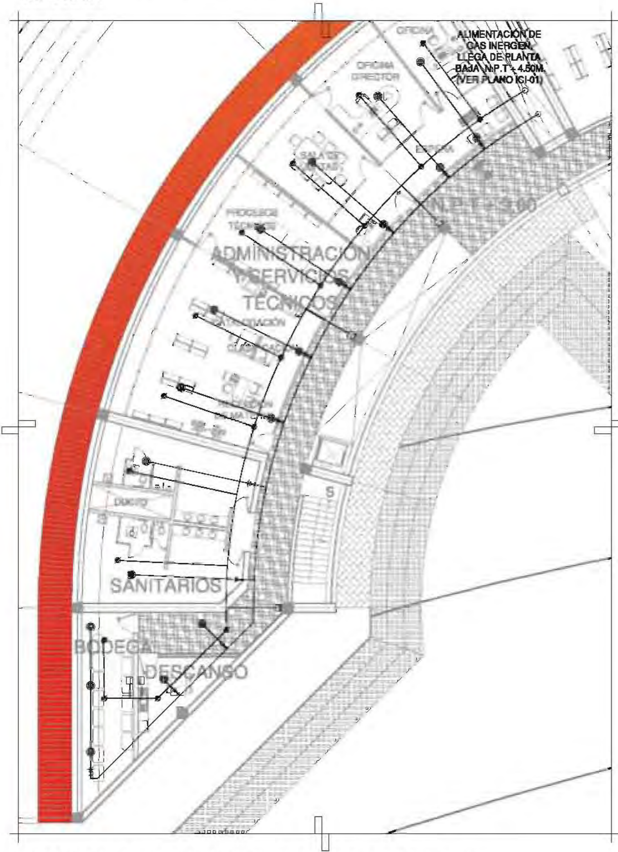
INSTALACIÓN CONTRA INCENDIO NIVEL + 9.00 m (ESC: 1: 100)
