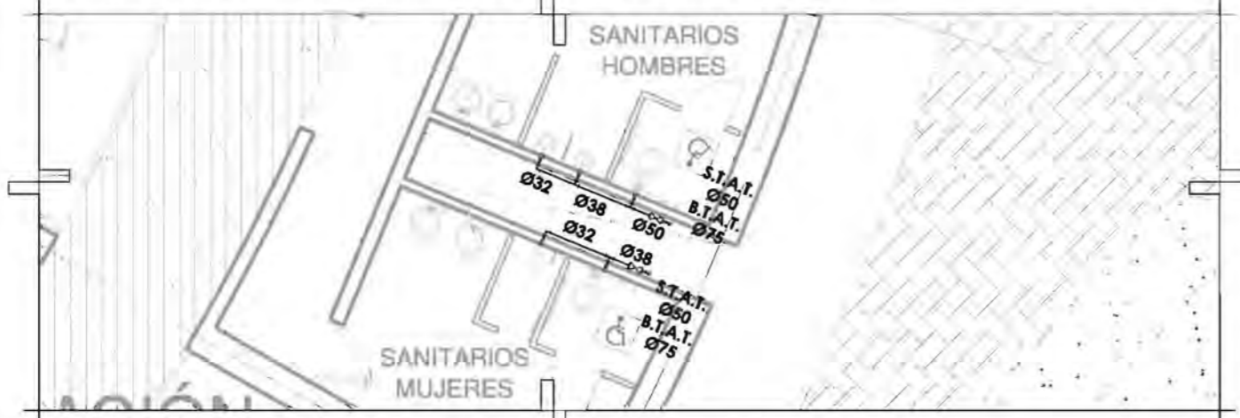
SANITARIOS ÁREA DE LUDOTECA, N.P.T. + 4.15m (ESC: 1: 50)
