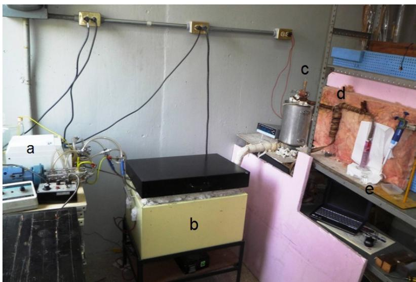
Figura 3-1: Dispositivo experimental utilizado en la piroconversión. a) Sistema de bombeo, b) evaporación, c) reactor, d) separación de sólidos, e) medición de la conversión.
