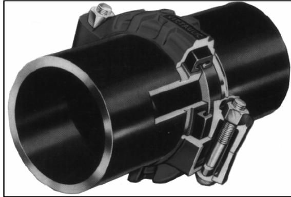
FIGURA 2.13 UNIÓN DE TUBERÍAS RANURADAS CON JUNTA METÁLICA
