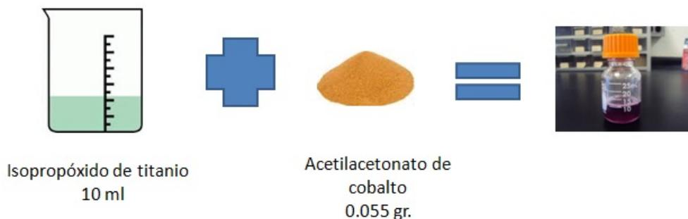
Figura 21: Precursor utilizado para el depósito de la película
