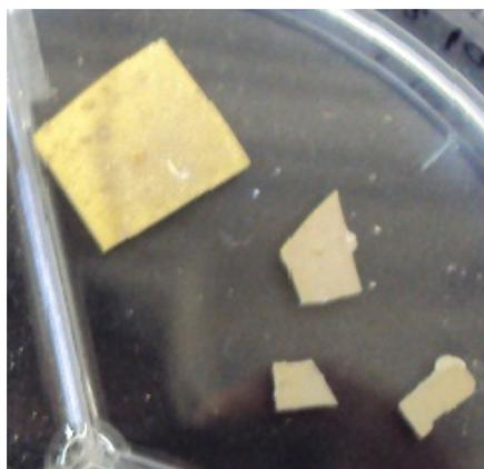
**Figura 25:** Películas depositadas sobre sustratos de vidrio y silicio
