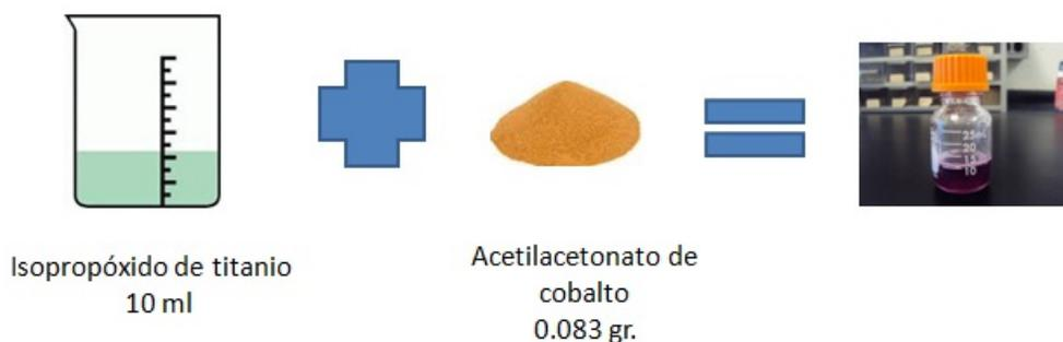
**Figura 22:** Precursor utilizado para el depósito de la película
