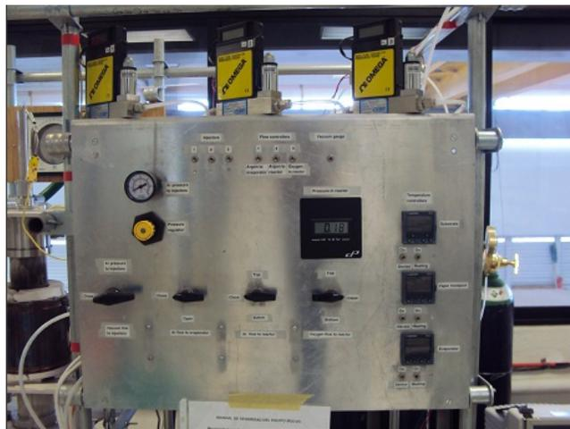
**Figura 16:** Panel de control donde se pueden tomar las lecturas de: presión, flujo y temperatura
