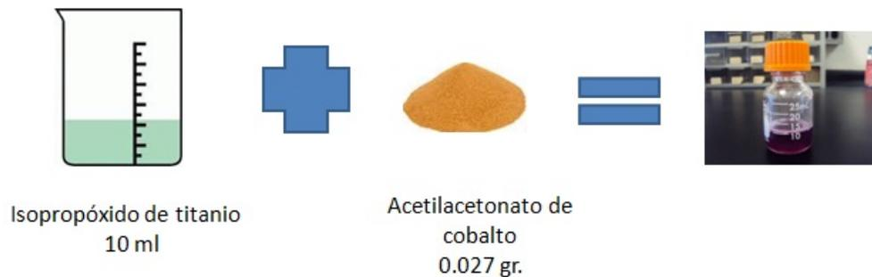
**Figura 20:** Precursor utilizado para el depósito de la película
