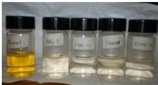
**Fig. 5.1: Viales después de 3 horas de iluminación UV para el colorante inicial y 4 películas diferentes**
