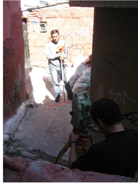
Fig. 9 y 10. Estación Total, marca Leica TC- 305 (izq.). Levantamiento Topográfico (der.).
