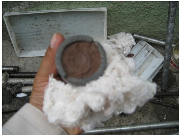
Fig.16 Recuperación de muestra de sondeo directo, el núcleo contiene un horizonte de Arcilla.
