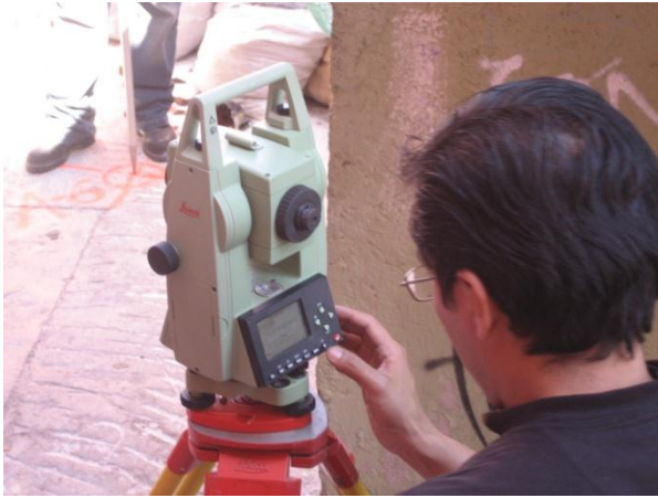
Fig. 9 y 10. Estación Total, marca Leica TC- 305 (izq.). Levantamiento Topográfico (der.).
