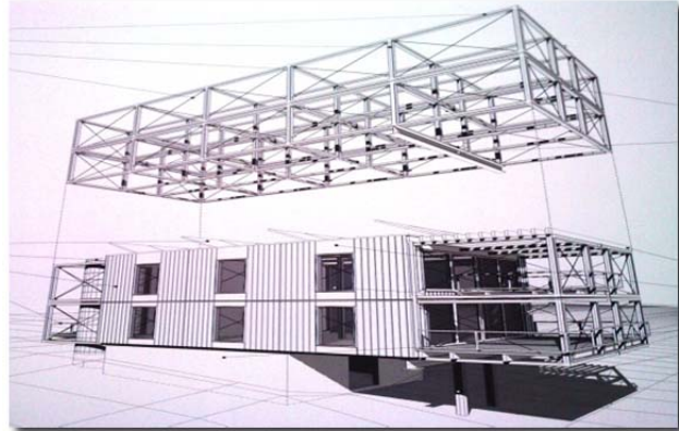
Ilustración 9. Vivienda Modular a base de Steel Frame. 22
