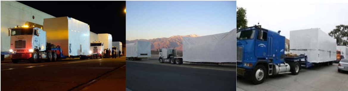
Ilustración 130. Transporte de módulos tridimensionales prefabricados del fabricante Marmol Radziner Prefab mediante remolques o tracto camiones de plataforma baja (low boy o góndola)
