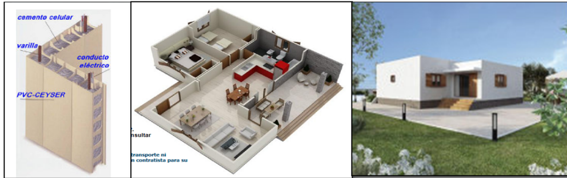
Ilustración 71. Panel de PVC (izq), Perspectiva interior de la vivienda con este sistema (centro), Perspectiva exterior de la vivienda (der) 137
