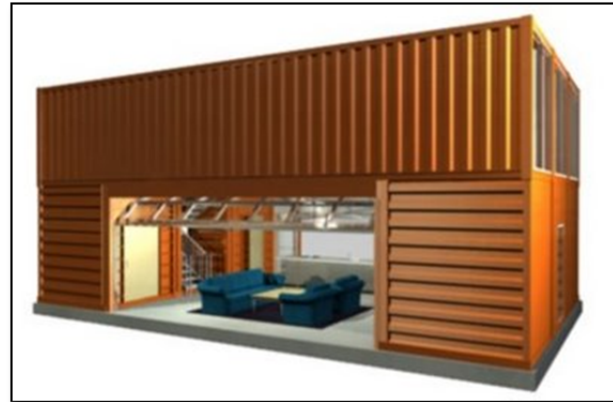
Ilustración 57. La casa prefabricada kit de reciclado de contenedores de transporte.
