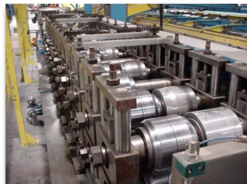
Ilustración 15. Proceso de fabricación de los perfiles de acero galvanizado. 38
