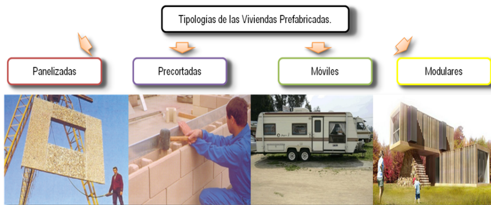
Ilustración 8. Tipología de las Viviendas Prefabricadas. Autor: Arq. Giovanni Jiménez Márquez.
