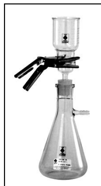
Fotografía 5.2. Dispositivo de filtración para extracción y cuantificación de clorofila-a
