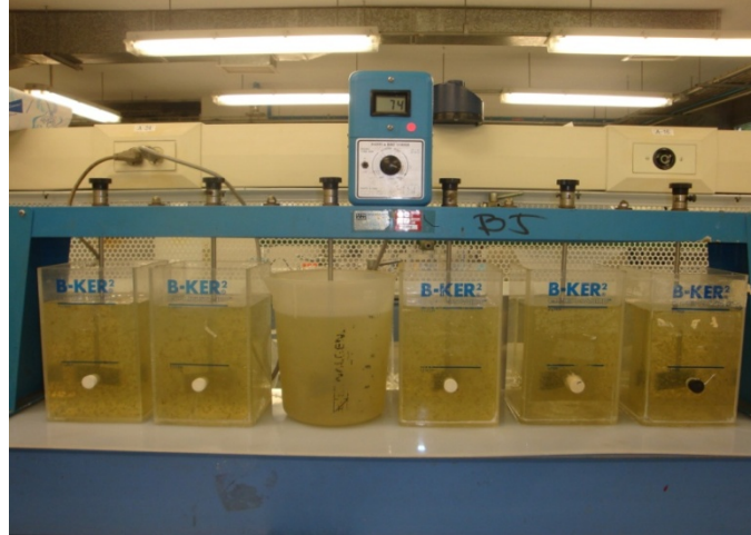
Figura 7.2 Sistema de prueba de Jarras para la determinación de la concentración óptima de floculante.
