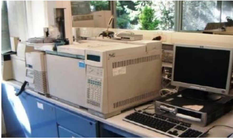
Figura 7.10 Cromatógrafo de gases HP 6890N, acoplado a un espectrómetro de masas modelo HP 5973N.
