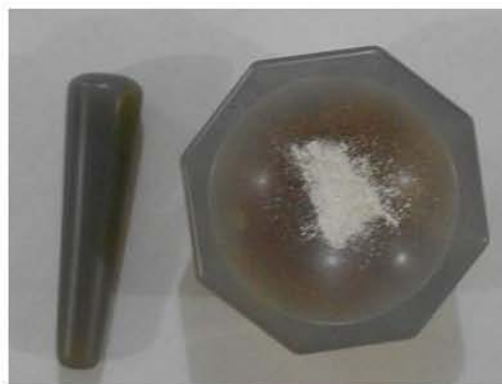
Figura 3.3. Polvos de \text{TiO}_2 extraídos del sustrato de FTO.
