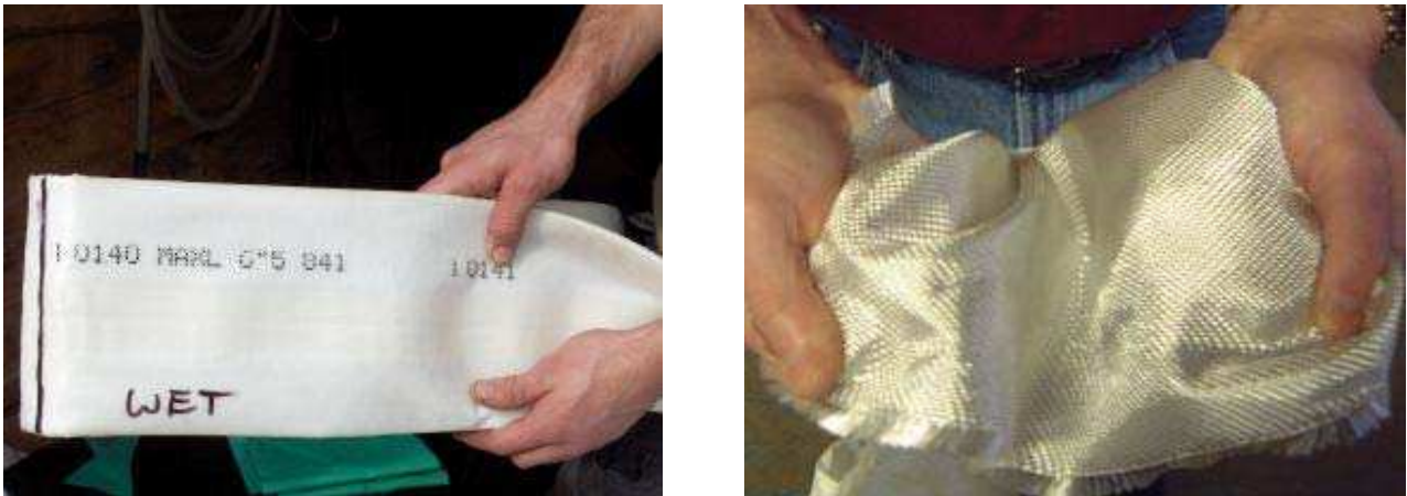
Fig. 4 Tipos de felpas usadas en el proceso de tubería curada en sitio CIPP (Izquierda, Tubo flexible sin reforzamiento, Derecha tubo flexible reforzado).
