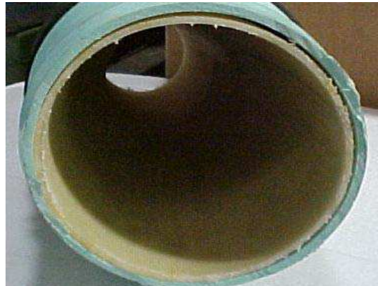
Fig. 6 Instalación de tubería con hueco ("gap").
