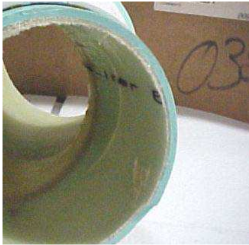
Fig. 7 Buen ajuste en el doblar de la tubería
