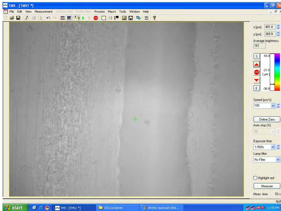
Figura 2.12: Canal microfluídico fabricado en laminas de poliestireno termoplástico
