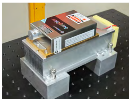
Figura 6.9: Láser fijado a la mesa mediante soportes fabricados a medida.
