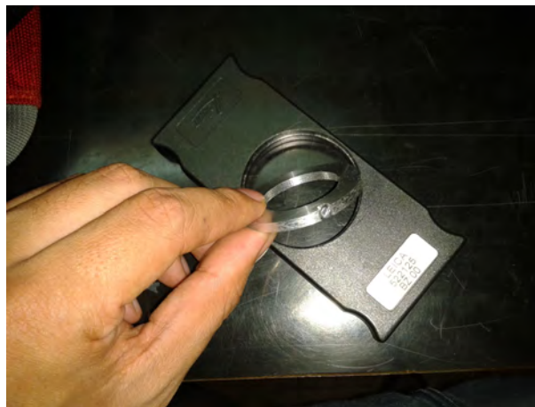
Figura 6.8: Soporte diseñado y maquinado del filtro paso largas empleado en el sistema de iluminación del microscopio.
