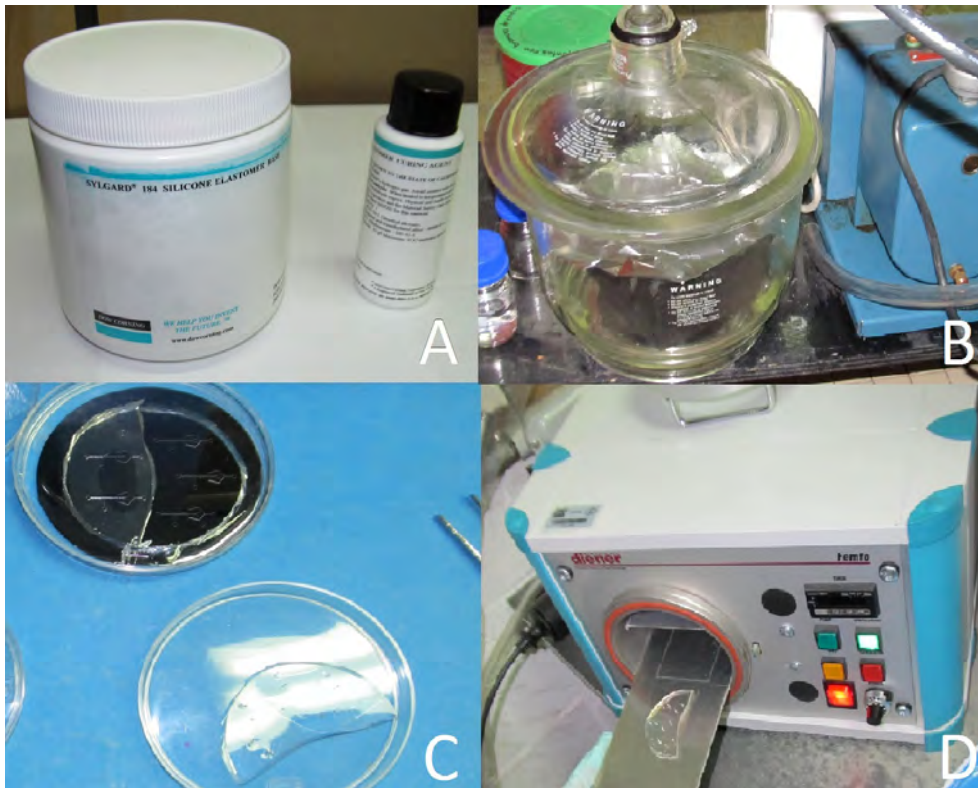
Figura 2.7: Fabricación de réplicas y sellado del chip microfluídico. 2.4.A Kit de PDMS marca SYLGARD 184 , 2.4.B Campana de vacío para degasificar las réplicas de PDMS, 2.4.C Réplicas extraídas del molde de SU8, 2.4.D Horno de plasma empleado para activar las superficies que sellarán el chip microfluídico.
