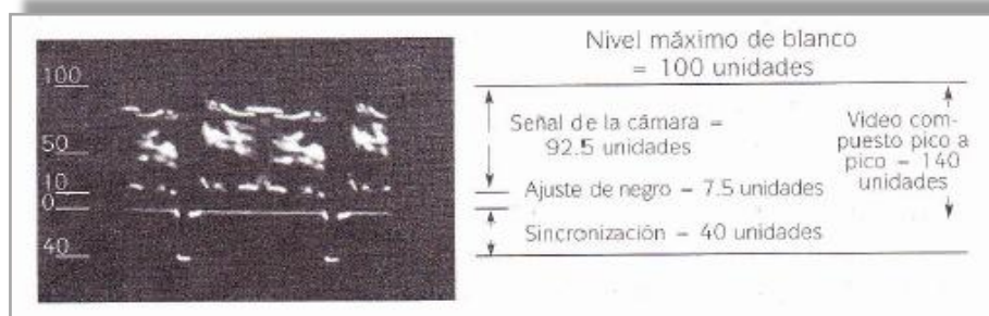
Figura 4-5 Imagen del osciloscopio de dos líneas de la señal de video.
