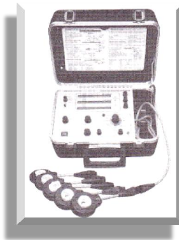
Figura 2-19 Probador y restaurador de CRT. Modelo Sencore CR7000 “Beam-Rite”, analizador y rejuvenecedor universal de CRT. (Sencore Electronics).
