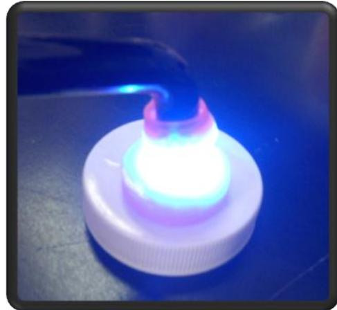
Fig. 17. Se fotopolimeriza el adhesivo por 10 segundos
