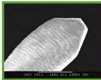
Fig. 3-7. Punta no cortante de instrumentos Mtwo. Tomada de <http://www.vdw-dental.com>
