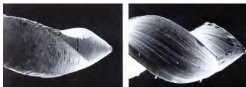
**Fig. 11-4. Fotomicrografía de la punta de la lima Flex R y de la lima Flex O. Tomada de Leonardo MR, Leonardo RT. Sistemas Rotatorios en Endodoncia, instrumentos de níquel-titanio. Sao Paulo: Artes Médicas Latinoamérica; 2002**
