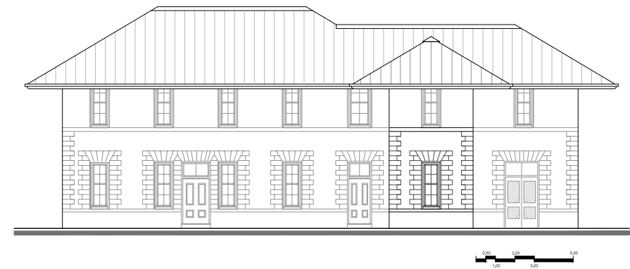
Figura 62. Redibujado de la fachada de la estación del kilómetro 170 del Ferrocarril Nacional de México, cercano a las de Tultenango y “El Oro”. En ambos casos se pueden ver coincidencias en la arquitectura, como el uso de tabique aparente en los enmarcamientos y techos inclinados con lámina de zinc. Fuente: CEDIF. Clasificación: N-170 + 107-0.9.1906.
