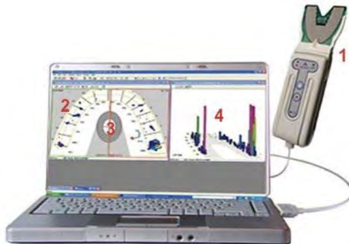
Fig. 5 T-scan. 1 Sensor 2 Vista en 2-D de la fuerza registrada 3 Centro de fuerza 4 Vista en 3-D.
