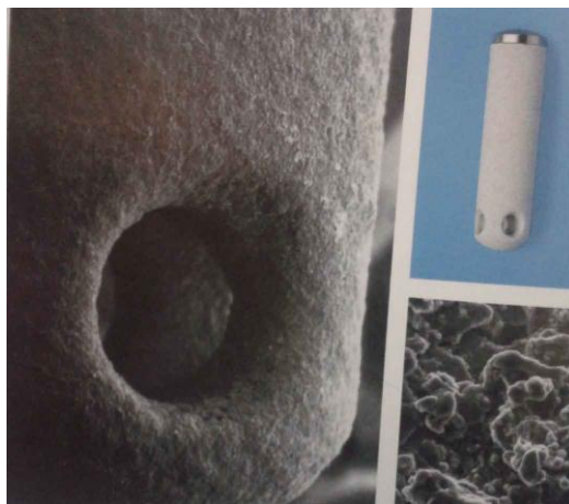
Fig. 6 Implante recubierto de Hidroxiapatita (MEB, x20)
