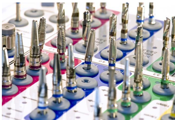
Fig. 21 Secuencia de perforación estándar para un implante roscado.
