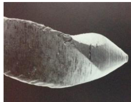
Fig. 53 Microfotografía de la punta de la lima Flex-R (punta Roane).
