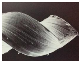
Fig. 54 Microfotografía de la punta de la lima Flexofile (punta Batt).
