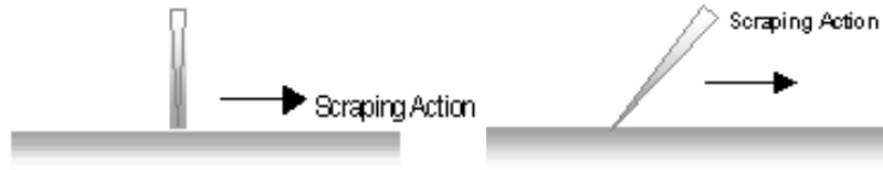
Fig. 46 Esquema de un ángulo de corte neutro y Fig. 47 Esquema de un ángulo de corte negativo.
