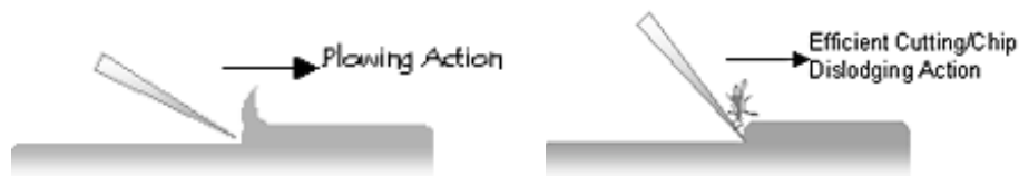
Fig. 44 Esquema de un ángulo de corte positivo excesivo y Fig. 45 Esquema de un ángulo de corte positivo.
