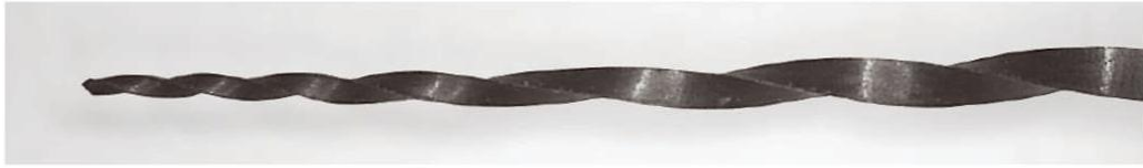
Fig. 78 Se observa como después de la aplicación de calor, las limas regresan a su forma original.
