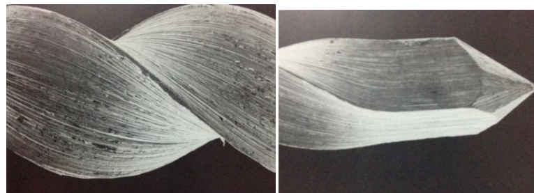
Fig.7 y 8 Microfotografías de la parte activa y de la punta activa de la lima tipo K
