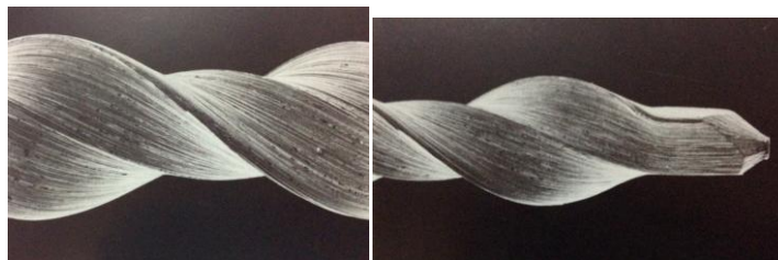
Fig. 20 y 21 Microfotografías de la parte activa y punta activa de la lima K-flex.
