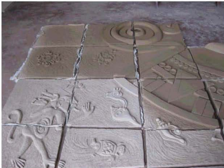
Observación y comportamiento de la deshidratación en las placas
