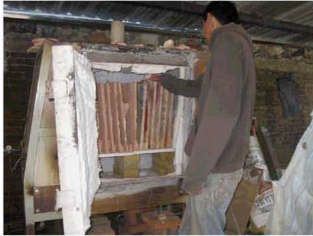
Distribución de las losetas en el horno
