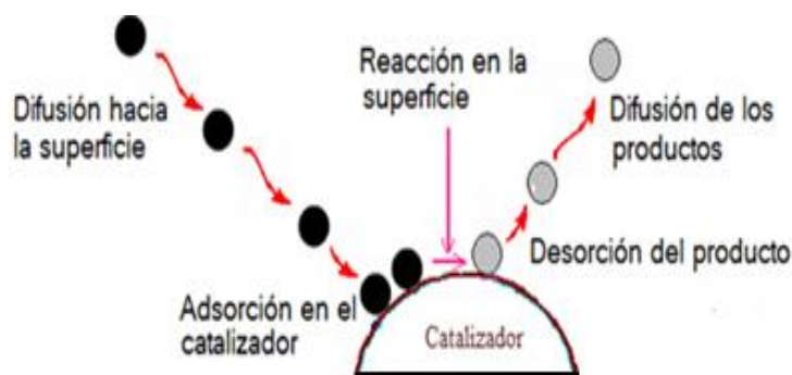
Figura 3.4.1. Mecanismo general de la catálisis heterogénea.
