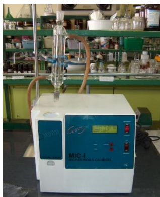
Figura 6.4.3.1. Equipo utilizado para las reacciones activadas con microondas
