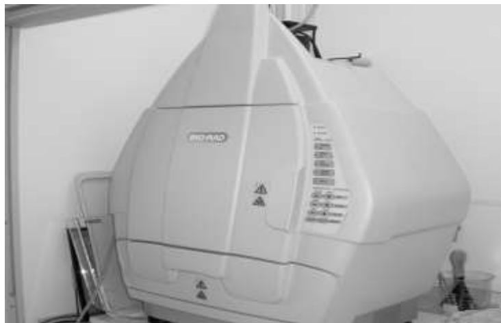
Fig. 4. Fotodocumentador de luz ultravioleta para geles de agarosa. (Imagen tomada directamente de productos BIO-RAD. www.bio-rad.com )
