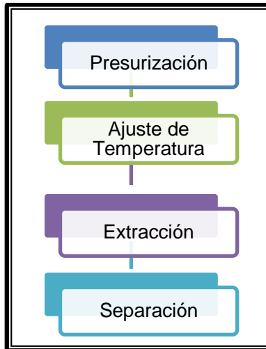
Figura 10. Proceso de extracción con Fluidos Supercríticos (FSC)
