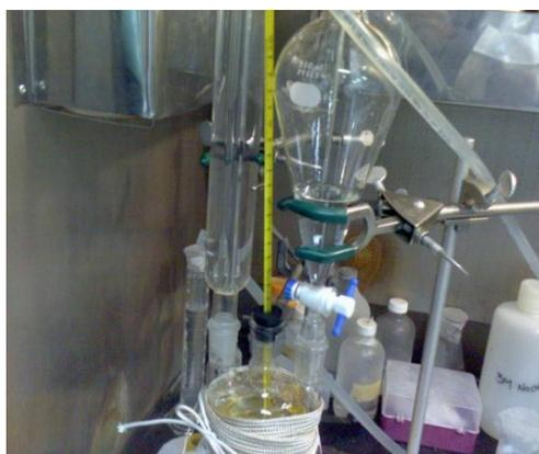
**Figura 2.1** Sistema para la síntesis hidrotérmica de ZnO y ZnO:Mn.
