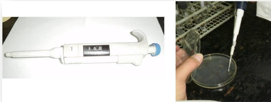
Figura 21. Micropipeta de 500µl, siembra de diluciones en Agar Rogosa.
