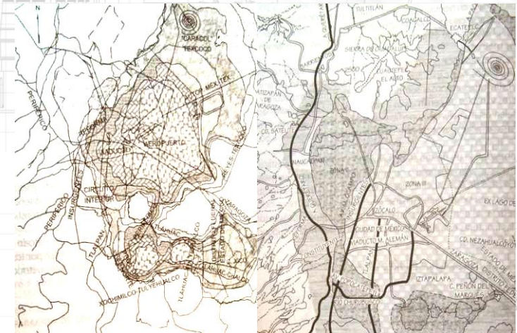
El predio se ubica en una Zona Geotécnica del tipo II, (Transición), por lo que se deduce que los estratos arenosos se encuentran a -20 metros, y la resistencia del terreno es de aproximadamente 5 T/m2.
