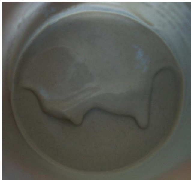
Figura 7: Barita Asentada en el Fondo de un Vaso de Precipitados
