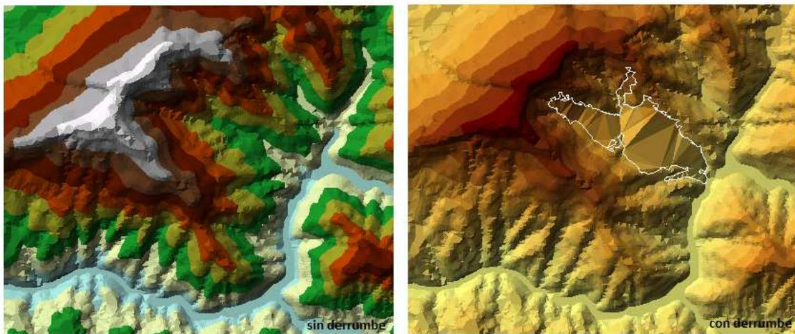
En la figura 4.29 se muestra la construcción de un modelo digital del terreno a partir de curvas de nivel. Mientras que en la figura 4.30. Se muestra en verde el área de tierra que está propensa a deslizamientos el mismo procedimiento se utilizaría para calcular movimiento de tierras. La operación entre dos superficies, proporciona una imagen con
