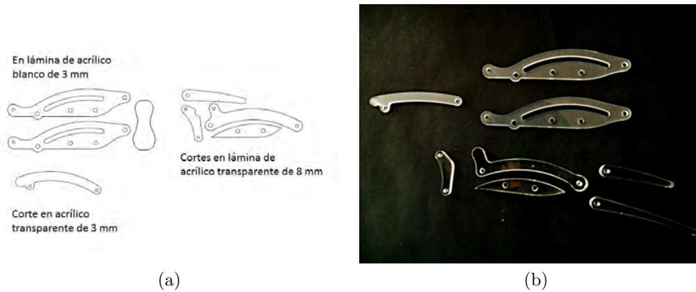
Figura 5.2: Perfiles de corte del mecanismo NA
