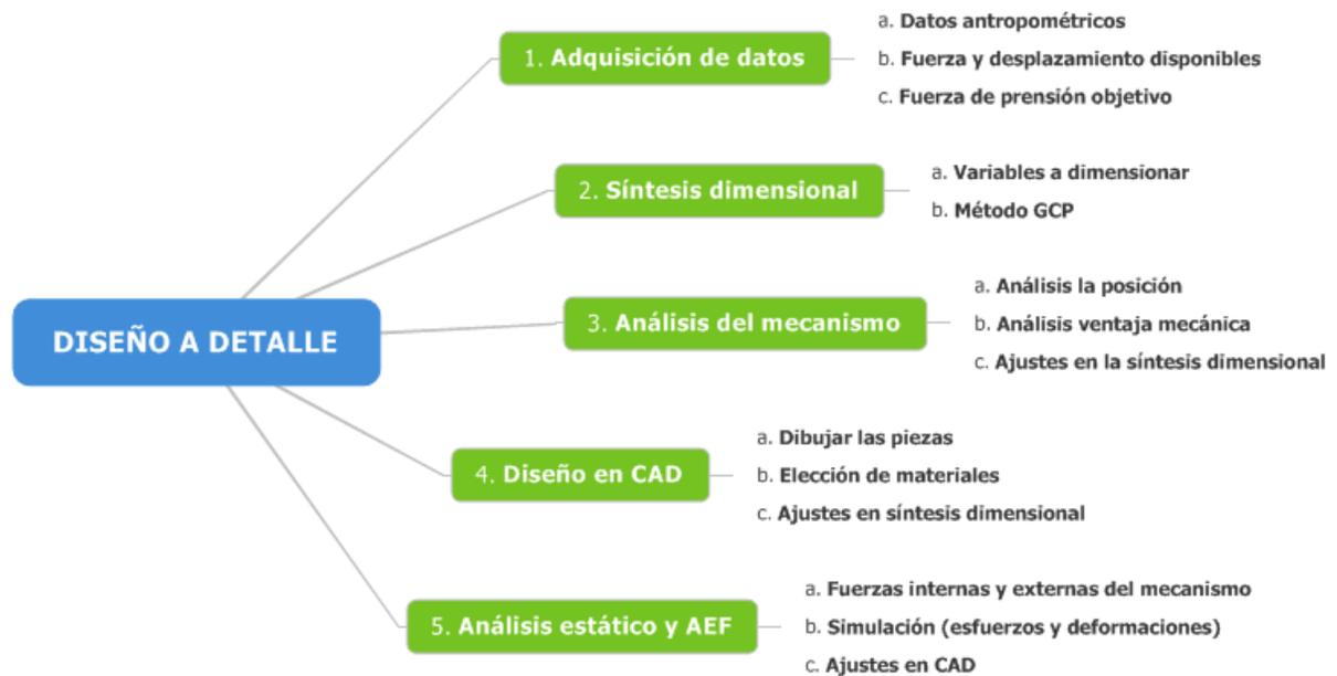
Figura 4.1: Proceso de diseño para la ortoprótesis
