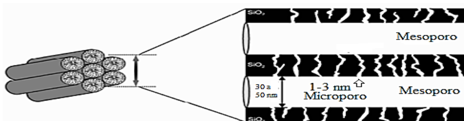
Figura 8: Representación esquemática de canales micro y mesoporosos que conforman el material SBA-15 [32]
