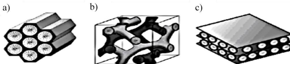
Figura 4: Estructuras de materiales mesoporosos de la familia M41S: a) MCM-41, b) MCM-48 y c) MCM-50 [26]
