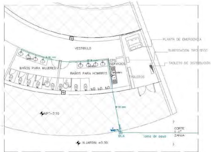
AGUA POTABLE (PEAD) BLOQUE DE SANITARIOS
