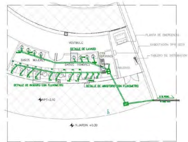
RED SANITARIA (AGUA TRATADA) BLOQUE DE SANITARIOS
