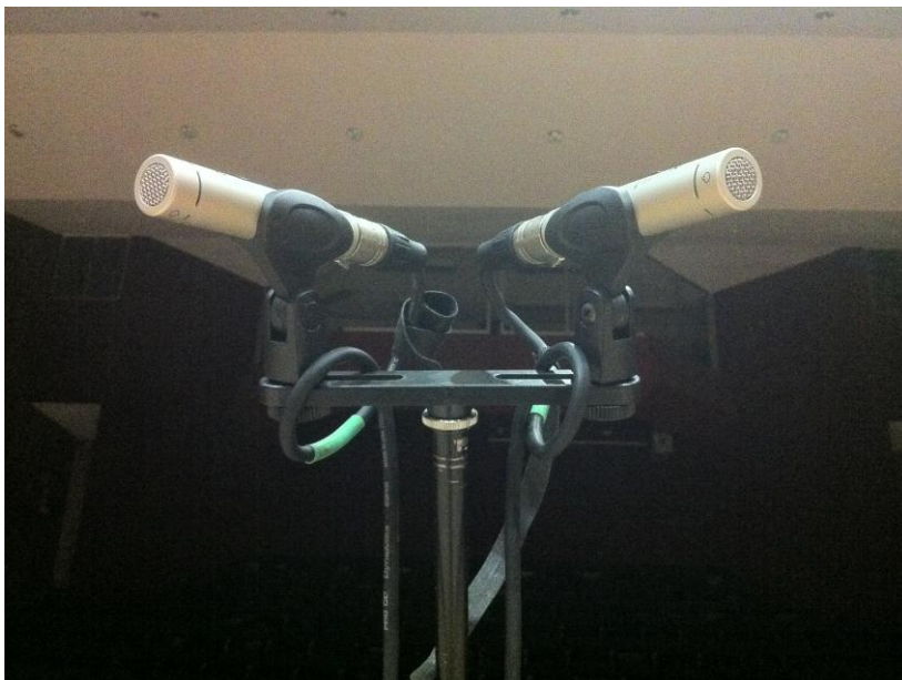
Figura 2 – Posicionamiento de micrófonos direccionales en ORTF.
